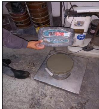
Anexo 13. Ensayo de contenido de aire (NTE INEN 3122)
