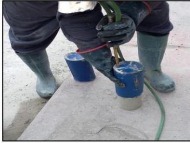
Anexo 14. Extracción de cilindros con un compresor de aire.
