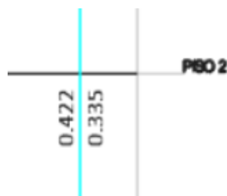
Figura 16. 6/5 capacidad viga/columna, Eje B-5, fuente ETABS
