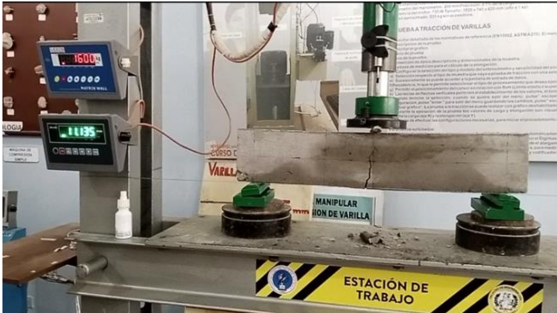
Ilustración 11: Viga 2 tras rotura.
