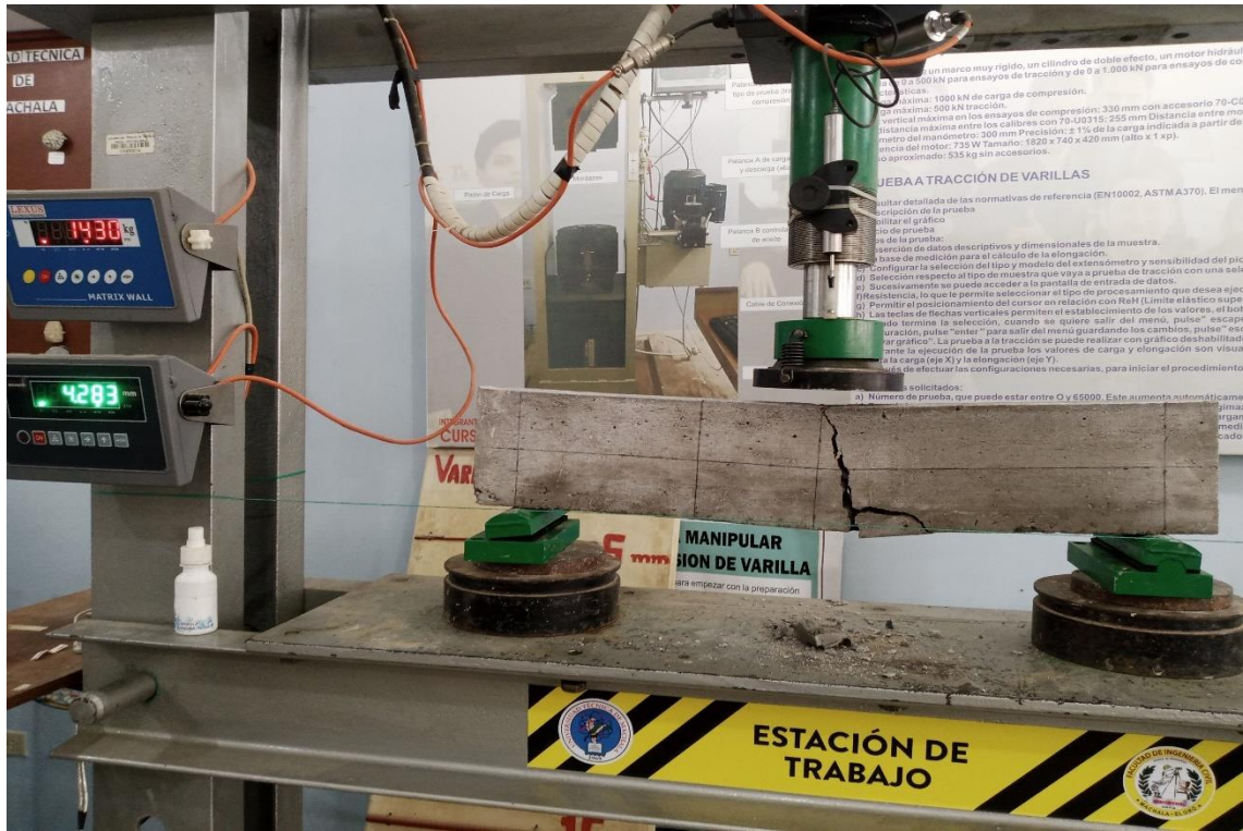
Ilustración 14: Viga tras rotura.
