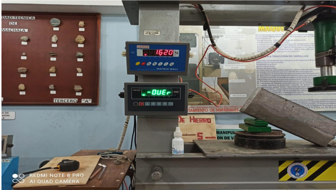
Ilustración 8: Viga 1 tras rotura.
