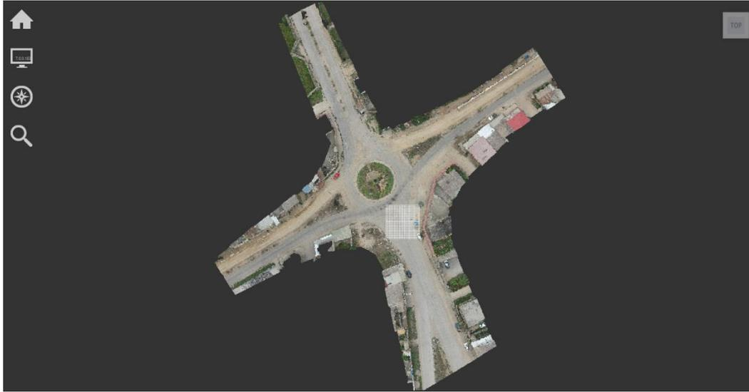
*Figura 8: Nube de puntos procesada en Recap*
