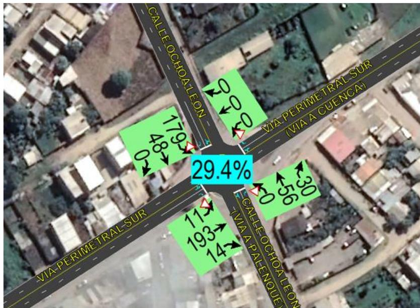
Figura 12: Esquema de tráfico de la intersección vial según conteo vehicular
