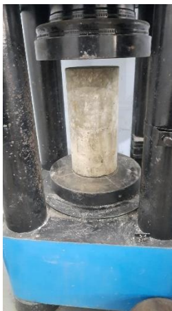
Ilustración 2. Ensayo de Resistencia a compresión - Colocación de Probetas
