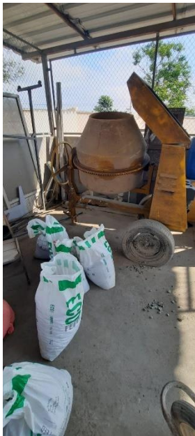
Colocación de agregados, cemento, y agua en concretera para fundición y vertido de mezcla en probetas cilíndricas
