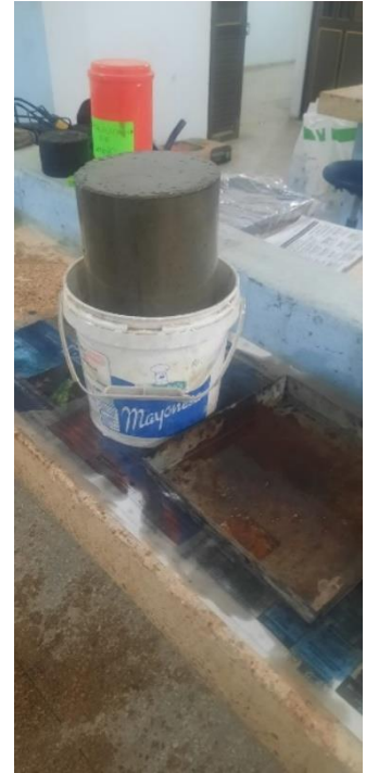
Colocación de probetas de hormigón dentro de recipiente con parafina líquida para curado
