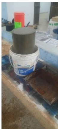
Figura 2. Probeta curada con parafina
