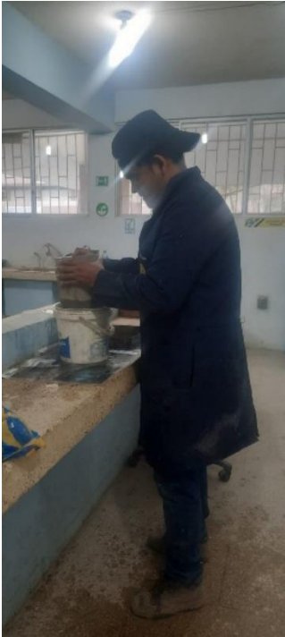
Colocación de probetas de hormigón dentro de recipiente con parafina líquida para curado
