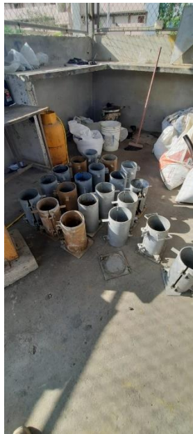
Colocación de agregados, cemento, y agua en concretera para fundición y vertido de mezcla en probetas cilíndricas
