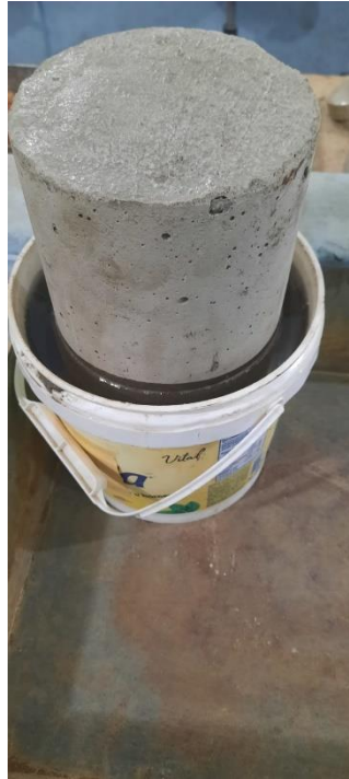
Colocación de probetas de hormigón dentro de recipiente con parafina líquida para curado
