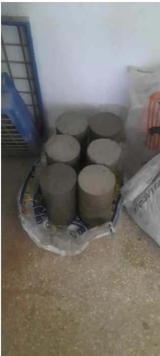
Colocación de probetas en un lugar fresco y protección con material de plástico
