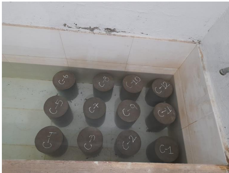
Figura 1. Inmersión de probetas en agua para curado
