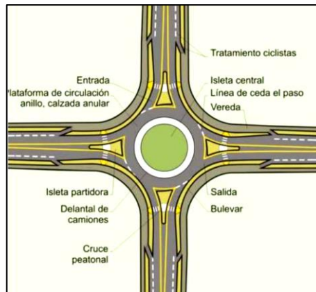
Fig 2. 1 Características de una rotonda.
