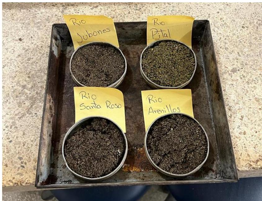
Colocamos las muestras en un recipiente más grande para después colocar en el horno.
