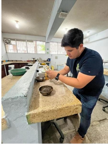
Extraemos la muestra del matraz para colocar en el horno.
