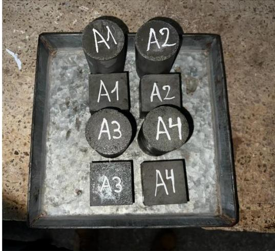
Extraemos los cilindros y cubos del tanque de saturación
