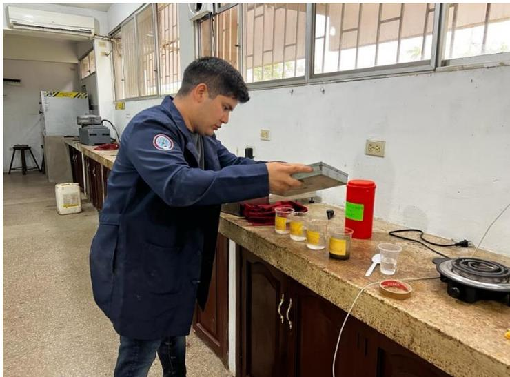
Colocar el agregado en la solución de metasilicato de sodio con agua
