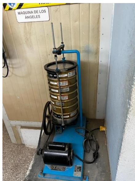
Tamizar el agregado con la máquina tamizadora
