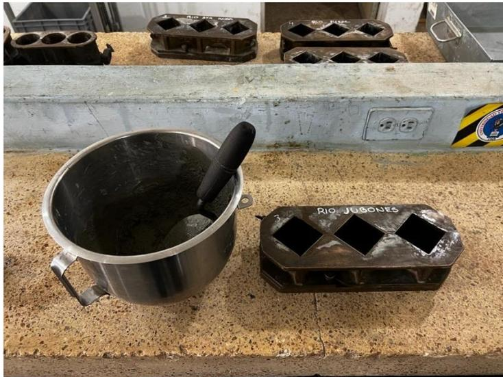
Colocamos la mezcla en los moldes
