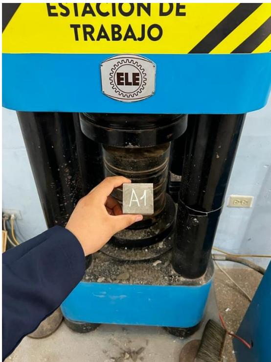
Colocamos los cubos y cilindros en la prensa hidraulica
