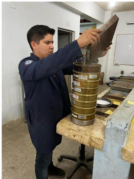
Colocar la muestra del agregado en los tamices
