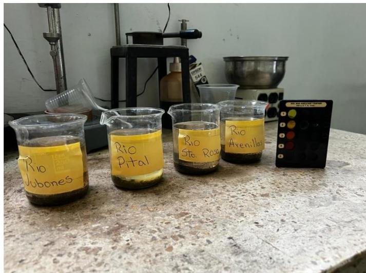
Dejar reposar por 24 horas para después comparar el color normalizado que se obtiene
