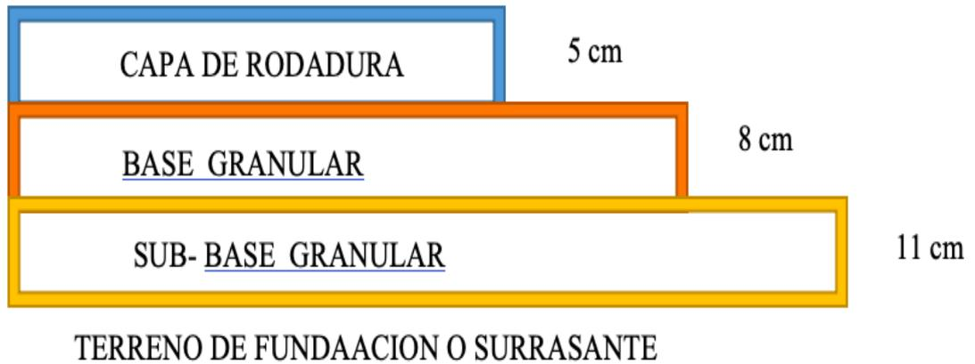
Se determina que para el camino vecinal descrito en el proyecto sus dimensiones de capas en su estructura son determinadas de la siguiente manera. 11 cm de sub- base realizada de una capa de material granular irregular para mayor firmeza al momento de su compactación. 8 cm de capa de base de material granular y 5 cm de capa de rodadura.
