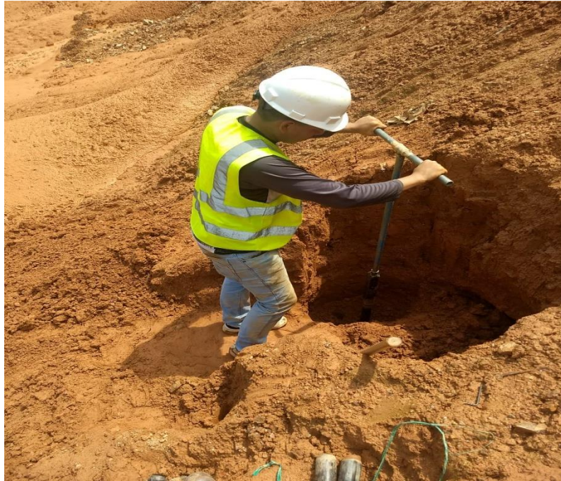
Ilustración 24. Extracción de muestras con Tubo Shelby
