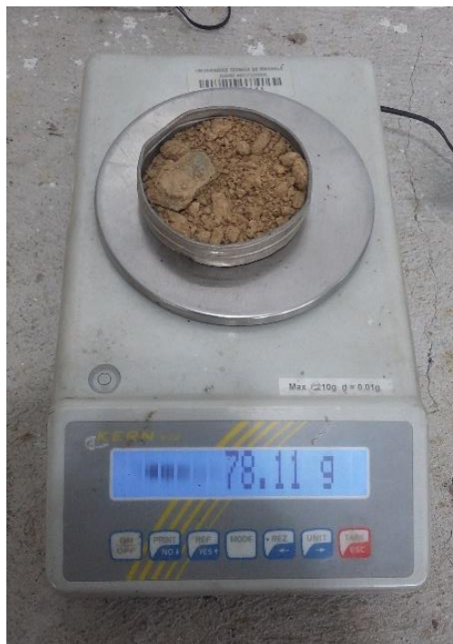
Ilustración 10. Peso seco de muestra para el contenido de humedad
