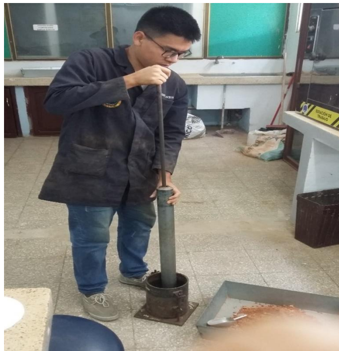
Ilustración 35. Compactación con número de golpes
