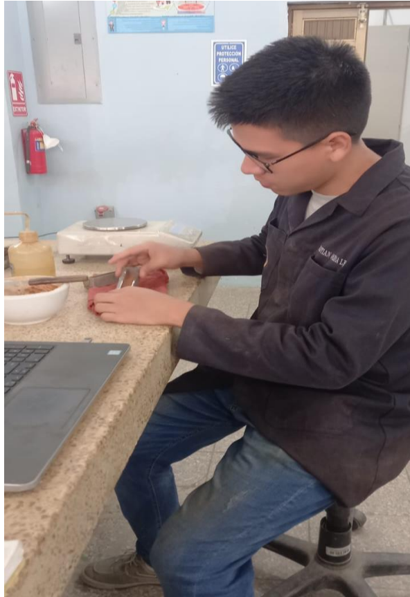
Ilustración 22. Colocación de muestra en el molde de contracción lineal
