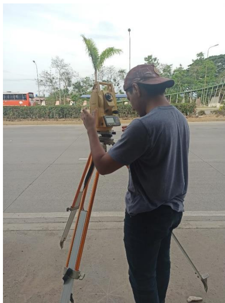
Figura 19: Nivelación del Equipo Topográfico [Elaboración Propia]
