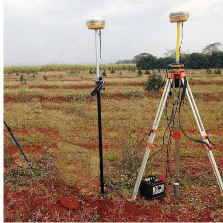
Figura 2: Sistema de medición con GPS-RTK [4]
