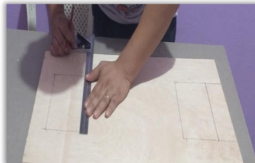
Imagen 16. Replanteo en tablero
