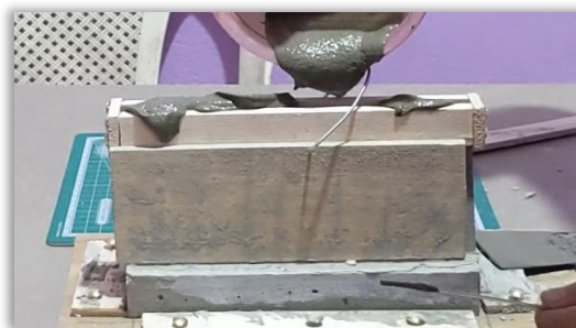
Imagen 14. Colado de hormigón en acero superior de estribo
