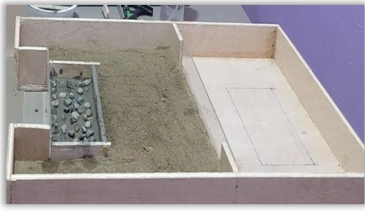
Imagen 20. Capa de hormigón ciclópeo para asentar estribo
