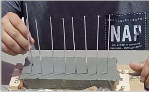
Imagen 5. Alambre #16 en cuerpo o pila de estribo
