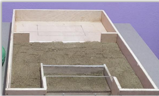
Imagen 19. Relleno de arena simulando terreno natural
