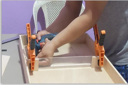
Imagen 17. Armado de tablero con Playwood y Acrílico
