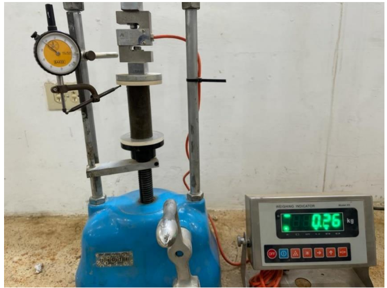
Ilustración 20- Medición de esfuerzos bajo carga
