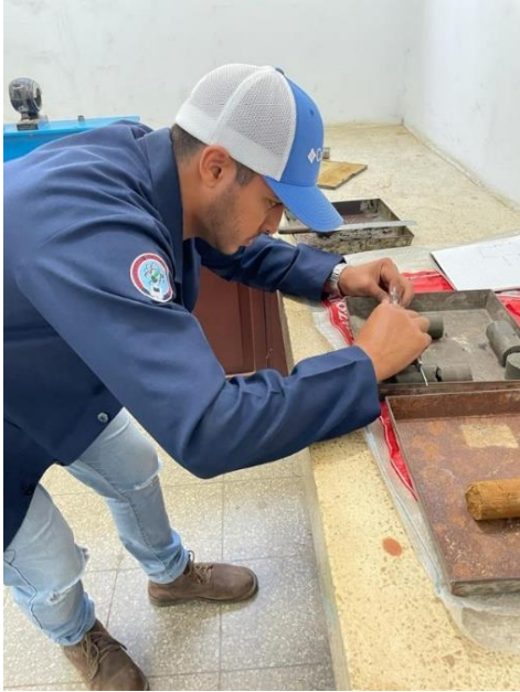
Ilustración 21- Toma de medidas de la muestra cilíndrica
