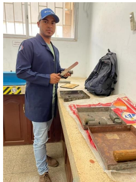
Ilustración 19 - Tallando la muestra cilíndrica para la toma de medidas
