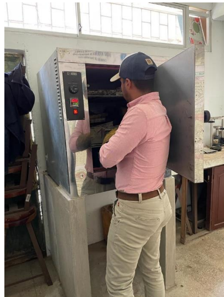
Ilustración 22 - Secado al horno para saber el porcentaje de humedad
