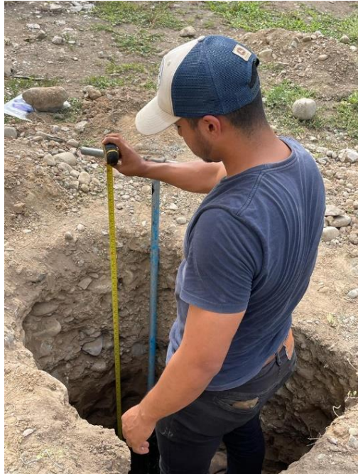
Ilustración 16- Medición de calicata en la cual se extrajo la muestra con el tubo shelby
