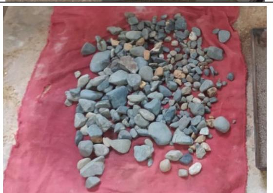
ENSAYO DE PESO VOLUMETRICO SUELTO Y VARILLADO
