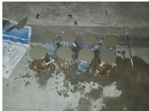
DESMOLDADO DE PROBETAS
