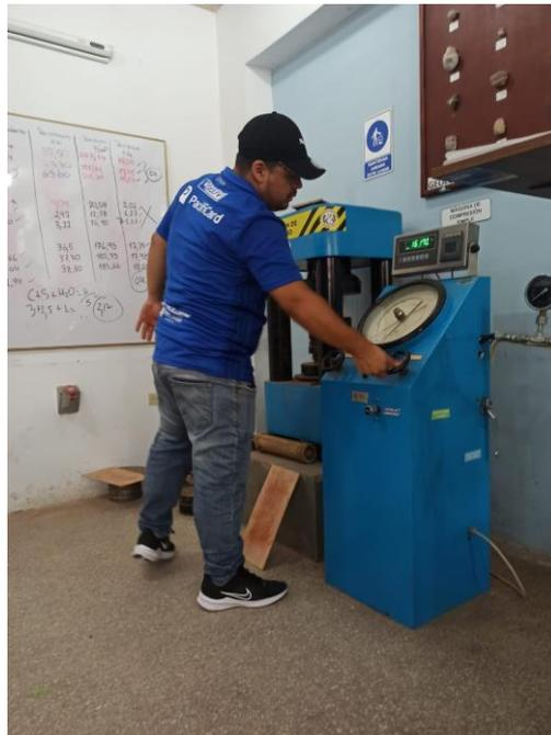
*Ilustración 2: Realización del ensayo de compresión [Elaboración propia]*
