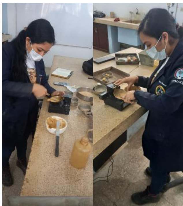
Ilustración 14 Ensayo del límite líquido
