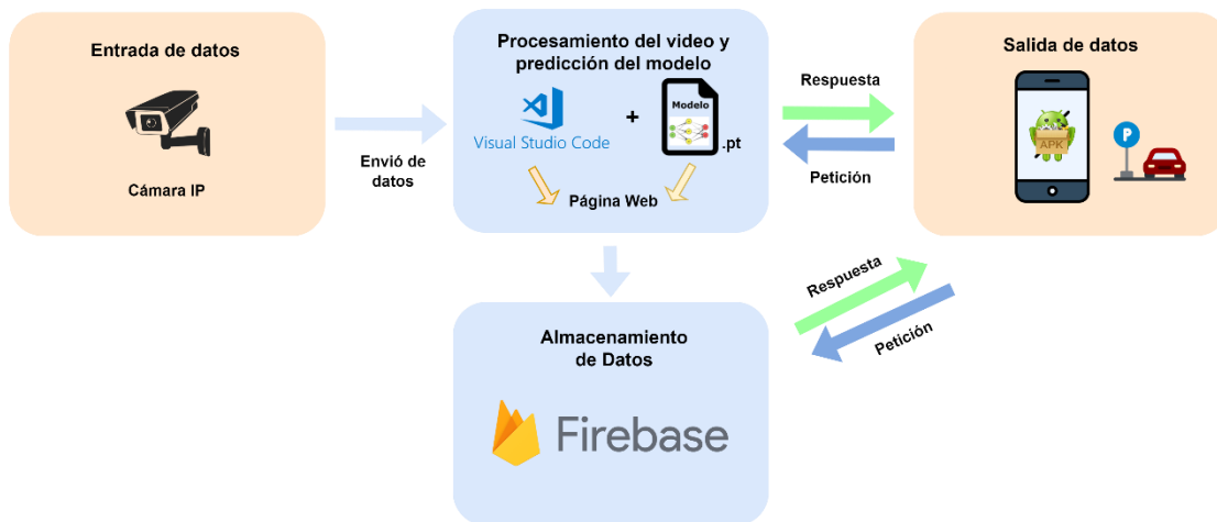
Figura 8. Arquitectura para la detección de plazas de estacionamiento
