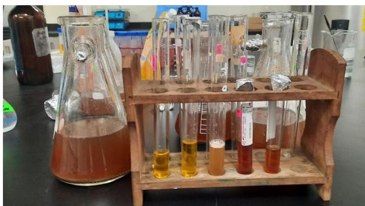
**Anexo 14.** Muestra para la lectura en el espectrofotómetro de UV-VIS con DNS
