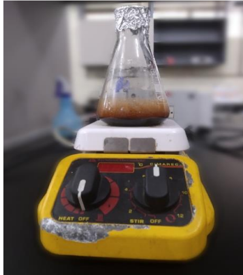
Anexo 3. Elaboración de muestras de taninos condensados para su posterior gelificación.
