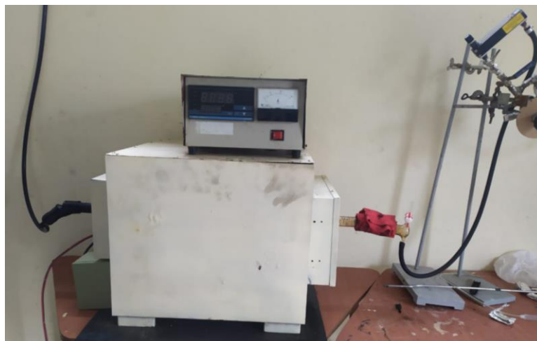
Anexo 7. Proceso de pirólisis de los geles de taninos condensados empleando la mufla.
