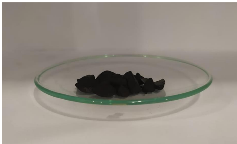
Anexo 8. Espumas de carbón a partir de geles de taninos condensados de semillas de uvas ( Vitis vinifera ).
