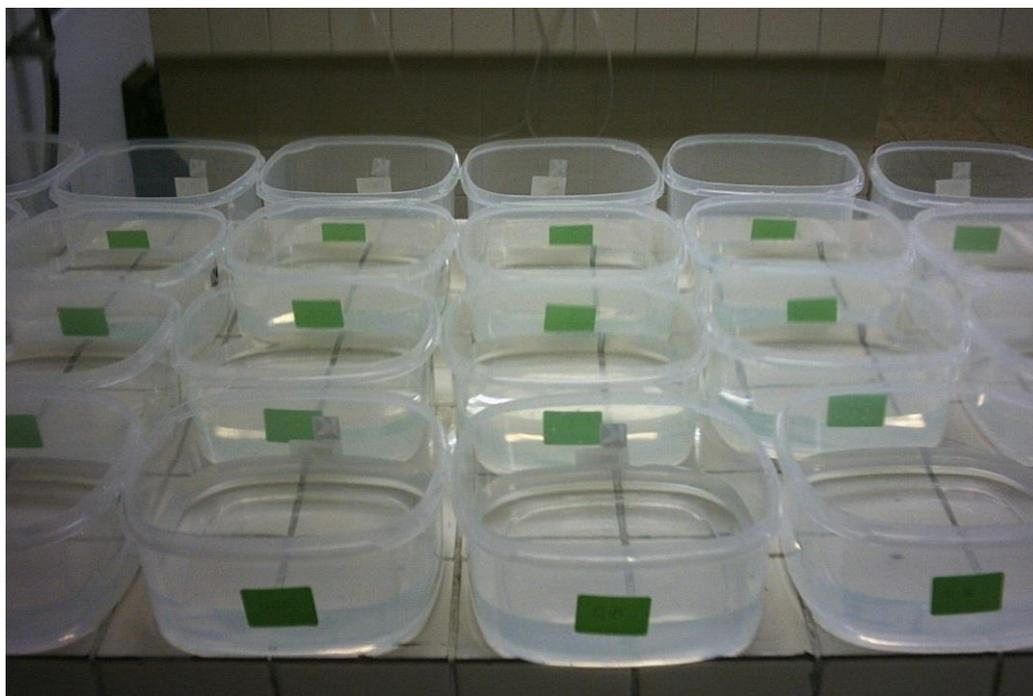
Foto 6.- Determinación del CL<sub>50-96</sub> horas en el laboratorio de Bioensayo.
