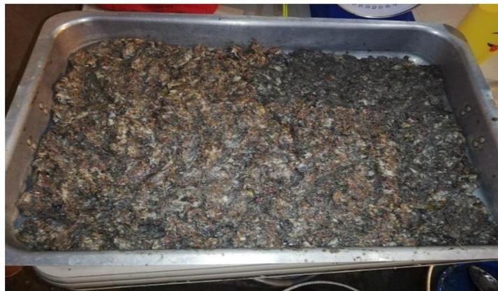
**Figura: 9** Obtención de la torta luego del prensado
