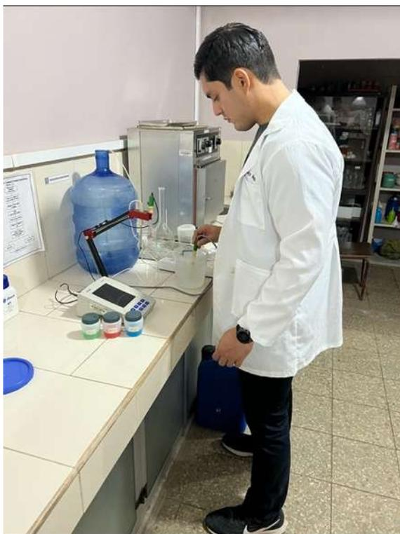
*Ilustración 7 Medición de pH.*
