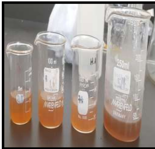
ANEXO 8. Análisis de acidez titulable en las almendras de cacao fermentadas y secadas
