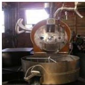
**Ilustración 4.** Máquina Tostadora de cacao. Adaptado desde Mera (2018).
