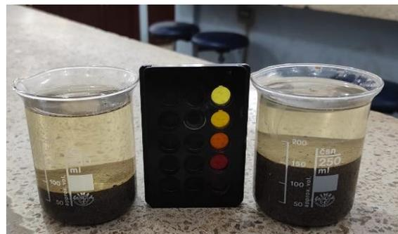
Colorimetría de la Cantera Sarmiento y Cantera Tuco León, cumplen con el color 3 normalizado, por lo cual es apta para ser usada para morteros o concretos.
