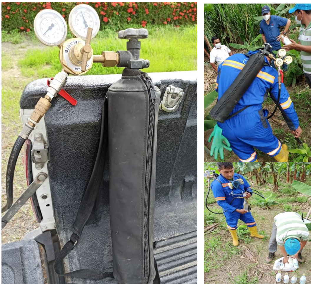
Figura 3. Equipo de aspersión utilizado para la aplicación de fungicidas de acuerdo con la técnica hoja simple o single leaf test (tanque de CO 2 , válvulas, manómetro y aplicador), para simular la descarga que realiza el equipo de aplicación aéreo de tipo comercial.
