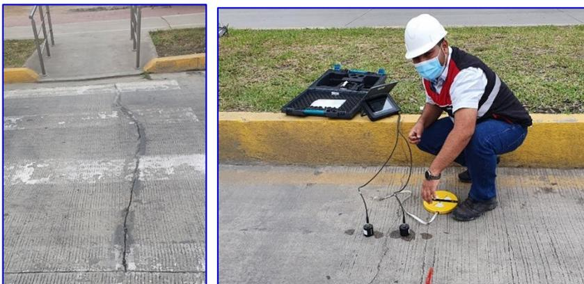
**Figura 11** Medición de la severidad de una grieta transversal.
