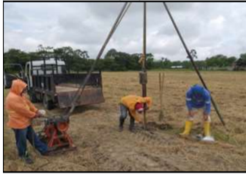
Ilustración 1: Ensayo de penetración estándar. Fuente: [9]
