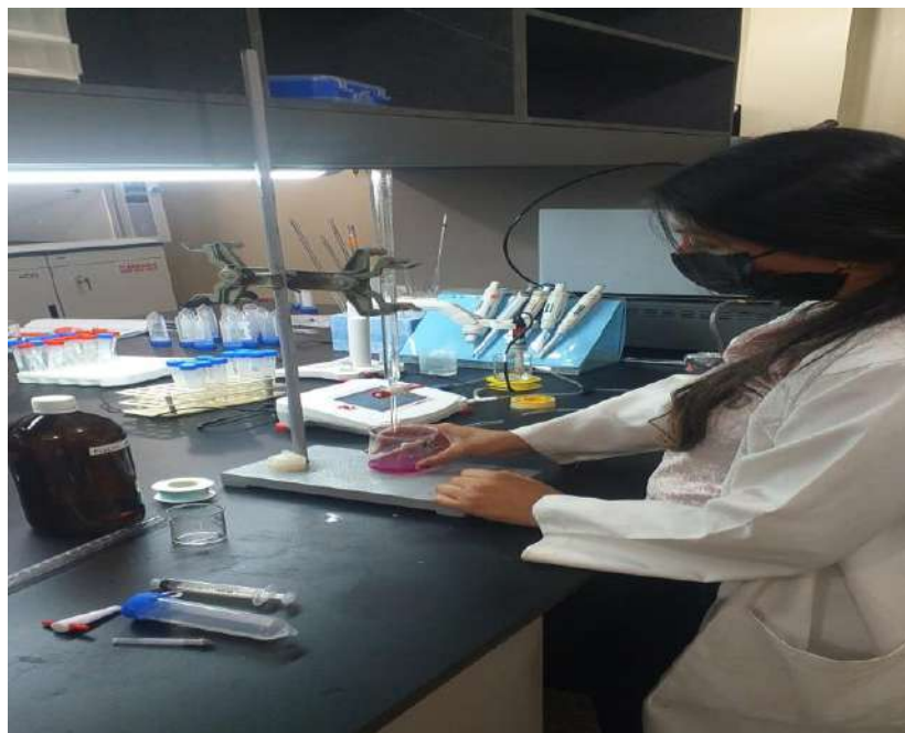
Anexo 9. Titulación con NaOH para método Boehm
