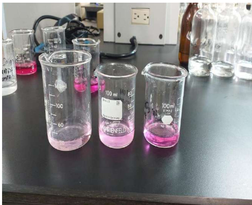
Anexo 9. Titulación con NaOH para método Boehm
