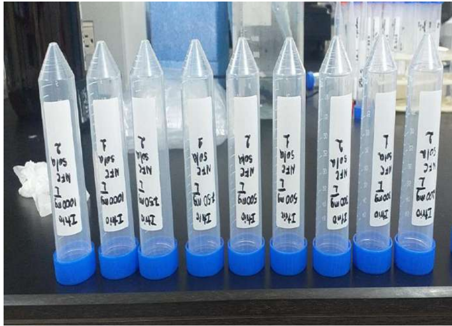
Anexo 13. Muestras de isotermas a diferentes concentraciones de itrio (25, 50, 75, 100, 200, 300, 500, 750 y 1000 mg/L)
