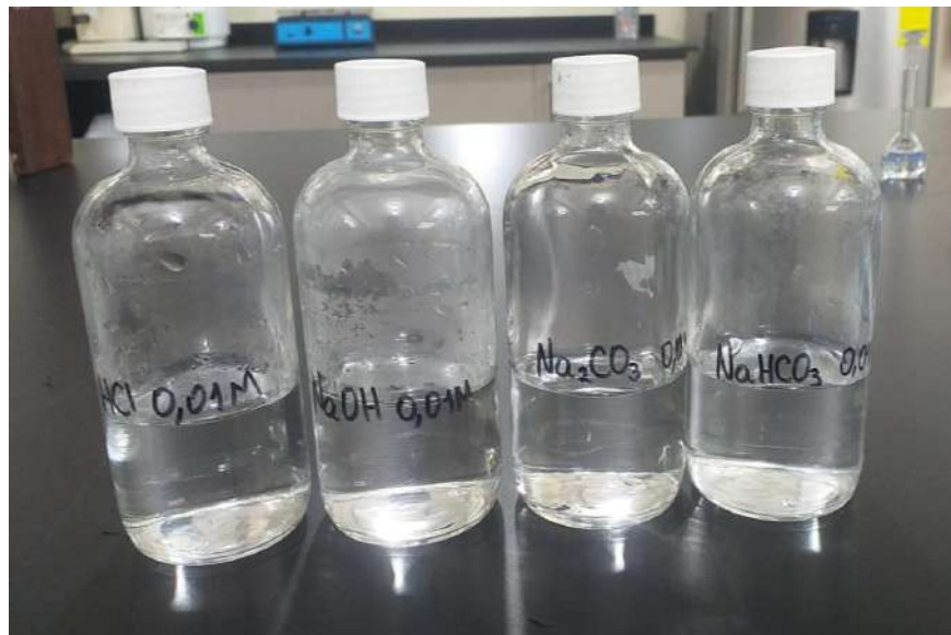
Anexo 6. Preparación de soluciones para titulación Boehm
