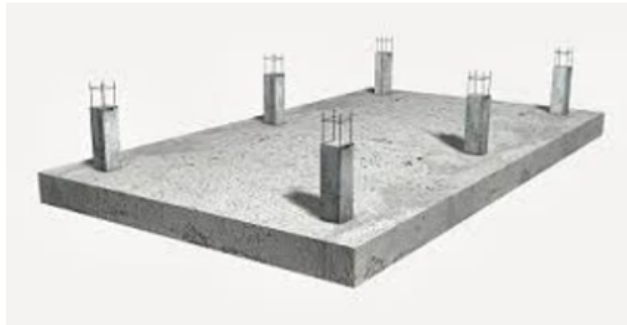
FIGURA 5. Losa de cimentación
