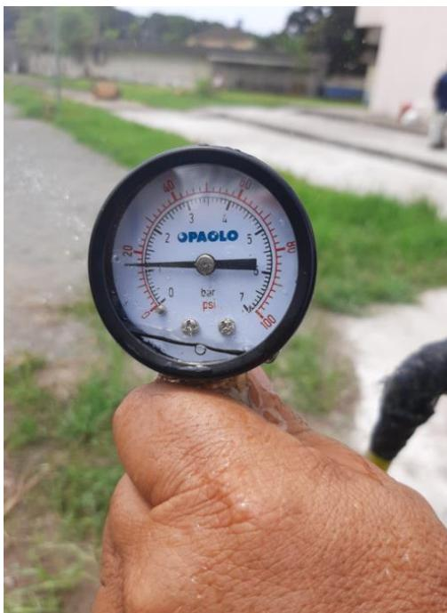
Foto 3. Presión manométrica 16 psi en grifo, Bloque Laboratorios
