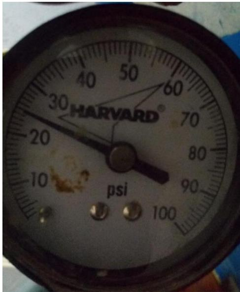
Foto 1. Presión manométrica 25 psi, tomada en sistema hidroneumático, bomba en reposo.
