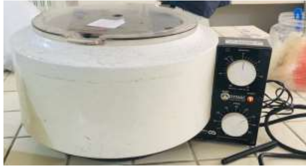
Ilustración 9: Centrifugadora, para obtener el suero para realizar el examen hormonal.
