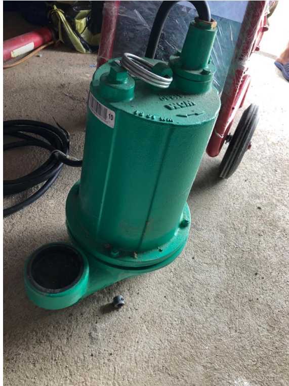
Figura 5. Bomba de lodo y desechos
