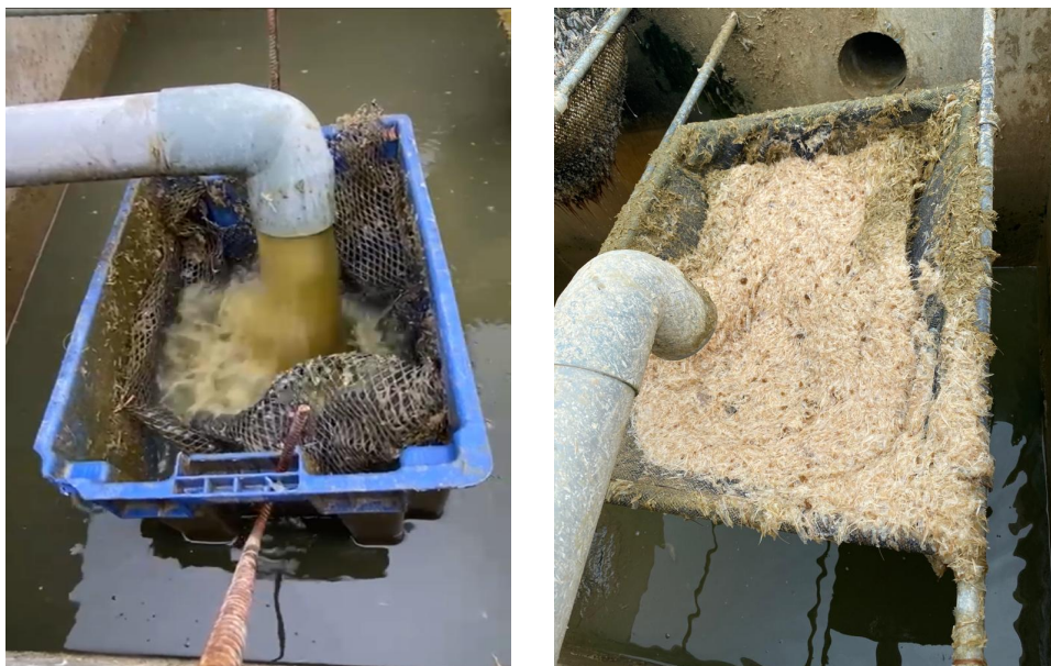
Figura 6. Funcionamiento del sifoneo para la recolección de desechos
