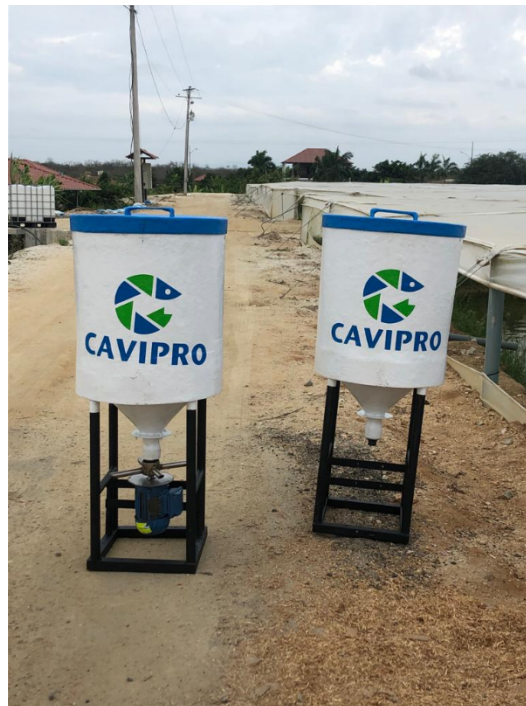
Figura 9. Alimentadores artesanales automáticos
