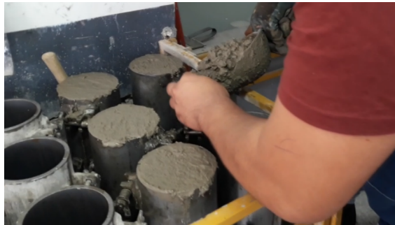
Fig. 2. Elaboración de probetas cilíndricas de hormigón.
