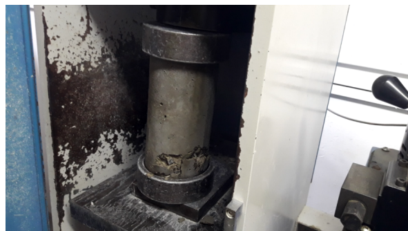
Fig. 3. Ensayo de compresión.
