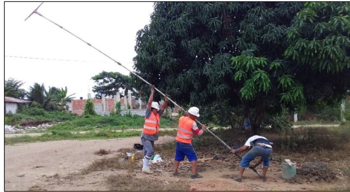
Fig. 6. Extracción de muestra inalterada en tubos Shelby (Sondeo #1).
