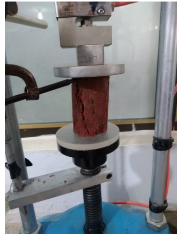
Fig. 20. Muestra de la Perforación 1 luego de ser ensayada.
