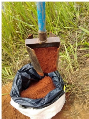
Fig. 17. Toma de muestra para ensayos de laboratorio en la Perforación 1.
