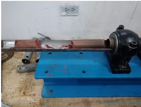
Fig. 19. Extracción de muestra del tubo SHELBY de la Perforación 1.
