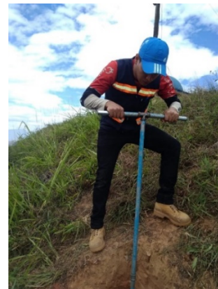
Fig. 18. Toma de muestra con el tubo SHELBY en Perforación 1
