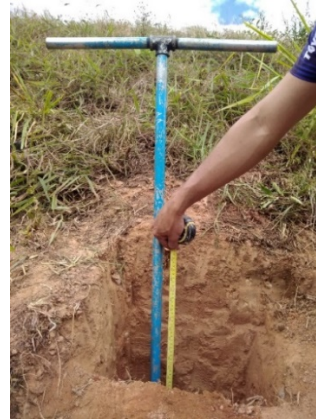
Fig. 16. Profundidad de 1,40m en la Perforación 1.
