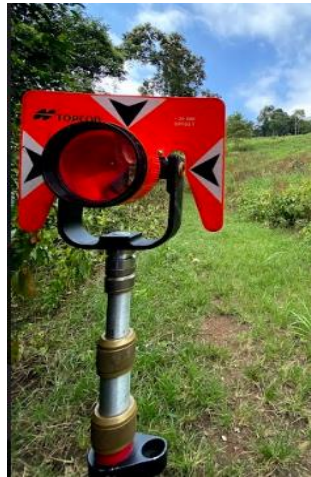
Ilustración 13: Jalón con prisma Fuente: (Autor, Johnny De la Rosa)
