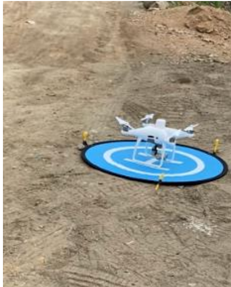
Ilustración 3: Dron dji Phantom 4 pro RTK
