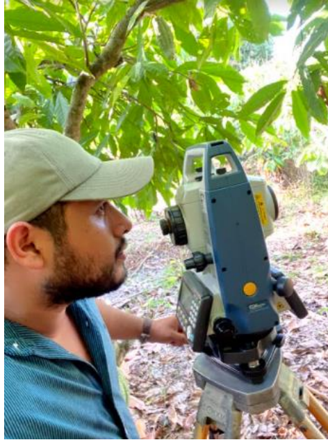
Ilustración 9: Levantamiento del Proyecto utilizando Estación Total.
