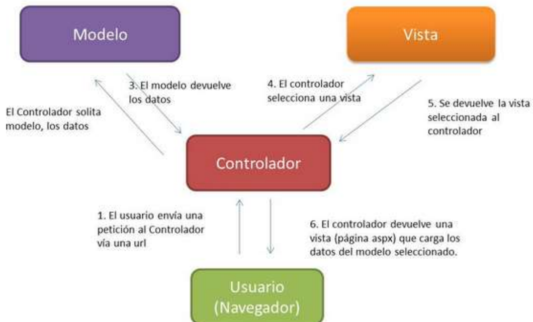
Figura 12. Patrón de Diseño MVC, elaboración propia del autor
