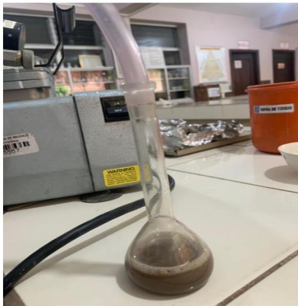
Anexo 6. Determinación de densidad real
