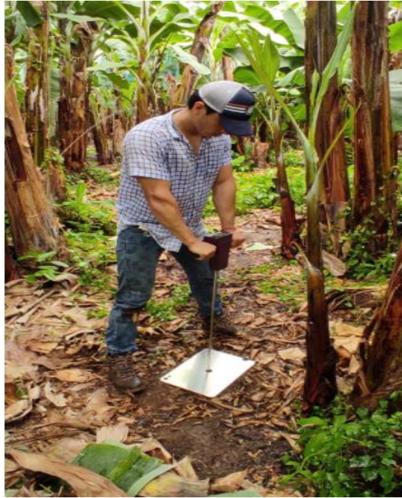
Anexo 3. Toma de datos con el penetrómetro
