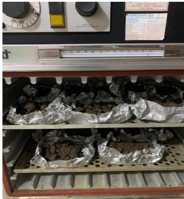
Anexo 4. Secado de muestras en estufa
