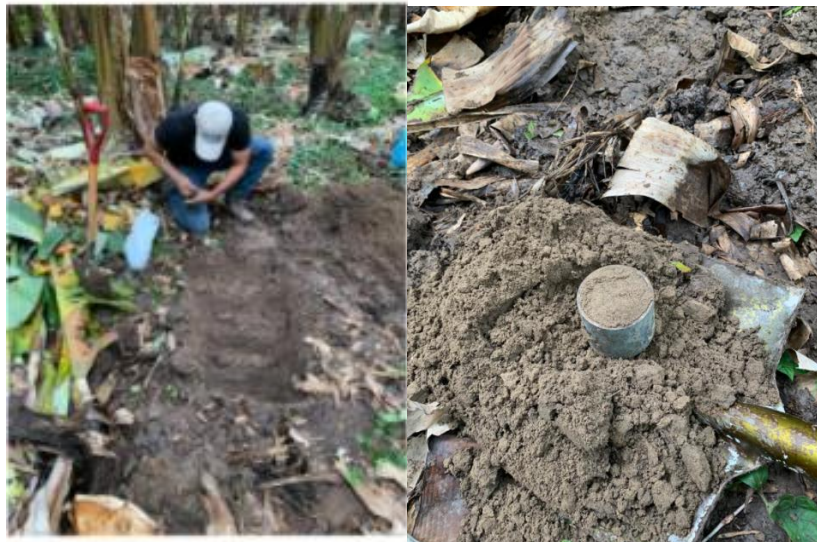
Anexo 2. Realización de calicata y toma de muestra mediante cilindro
