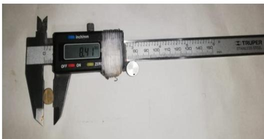
**Figura 11.** Ancho de la semilla medido con un calibrador o pie de rey.
