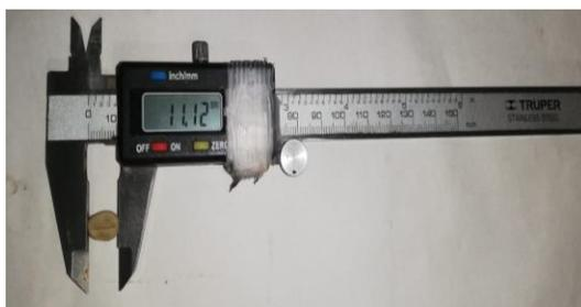
**Figura 10.** Largo de la semilla medido con un calibrador o pie de rey.
