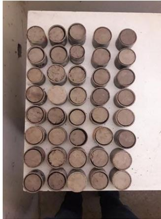
**Anexo 3.** Determinación de  $D_a$  por método de cilindro metálico
