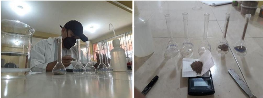
**Anexo 4.** Determinación de  $D_r$  por método del balón aforado
