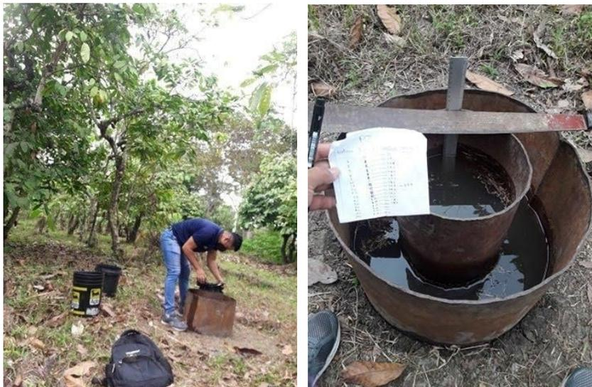
**Anexo 8.** Pruebas de infiltración con anillos de Munz
