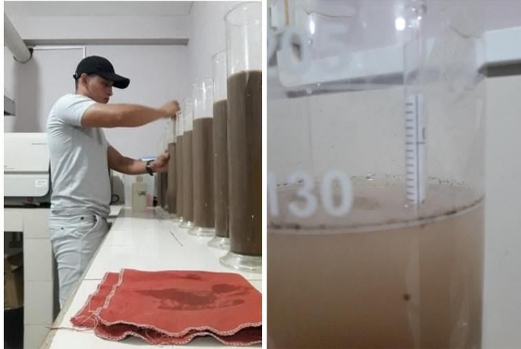
**Anexo 6.** Determinación de textura por método de Hidrómetro
