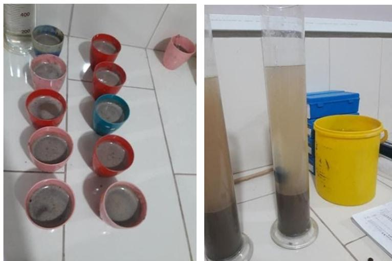
**Anexo 5.** Determinación de textura por método de Hidrómetro
