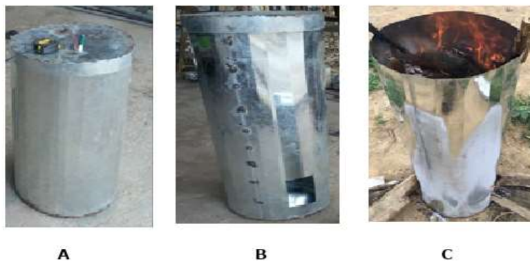
Figura 5: Elaboración de tanque para quemar biomasa Fuente: (Pilcorema et al., 2020)
