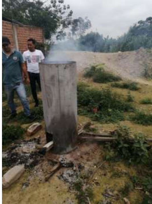
Anexo 6. Mazorcas de cacao secas y elaboración de biocarbón en horno artesanal
