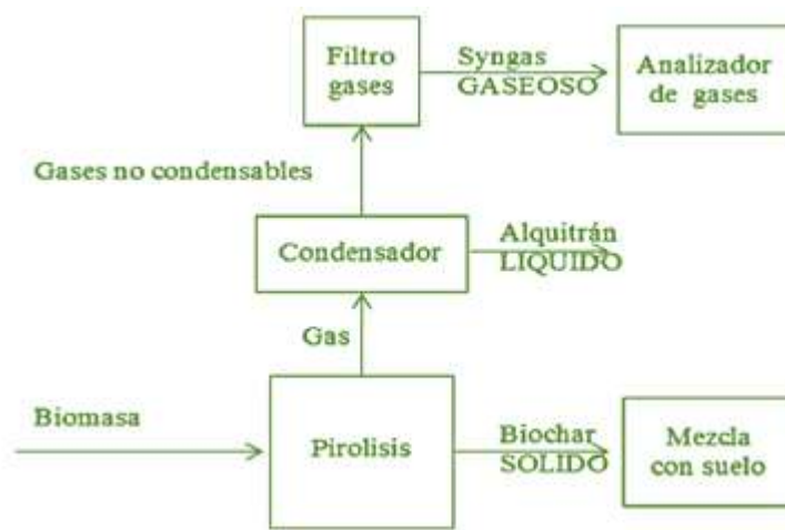
Figura 2: Esquema del proceso de pirólisis
