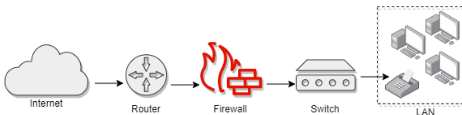
Figura 6. Implantación por defecto del Firewall
