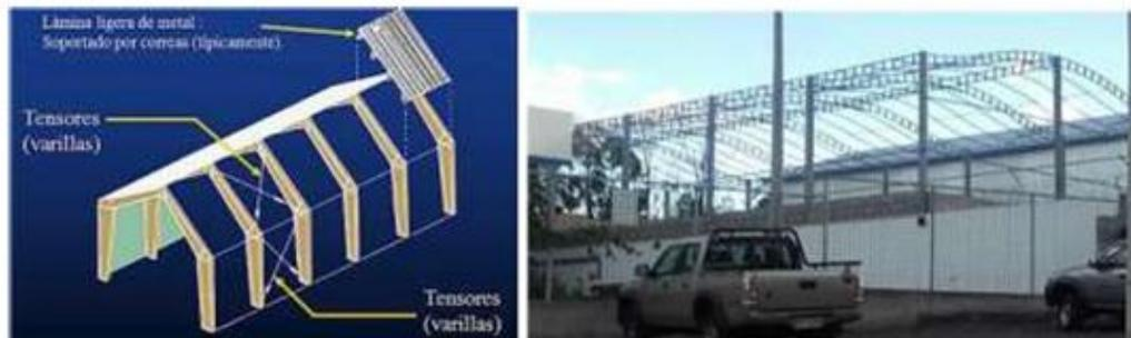
Pórtico de acero laminado con muros estructurales de hormigón armado (S4): Pórticos de acero laminado en caliente con muros estructurales de hormigón armado a todo lo alto de la edificación.
