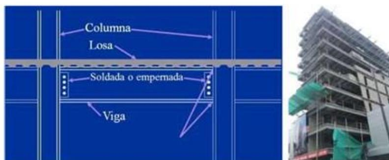
Pórtico de acero laminado con diagonales (S2): Pórtico de acero laminado en caliente y diagonales rigidizadoras de acero a todo lo alto de la edificación.
