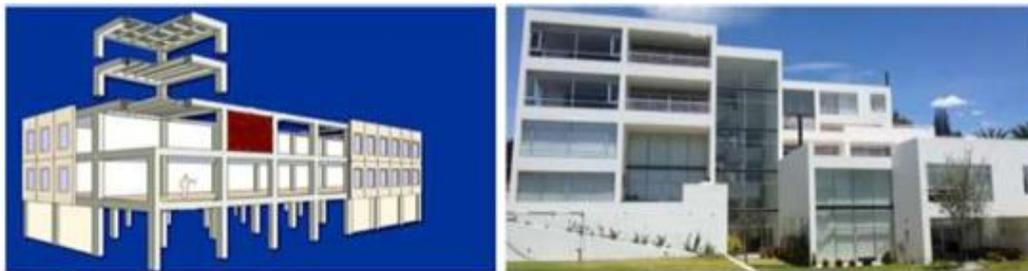
Pórticos de Hormigón Armado con muros estructurales (C2): Elementos estructurales vigas, columnas y muros estructurales de hormigón armado a todo lo alto de la edificación.
