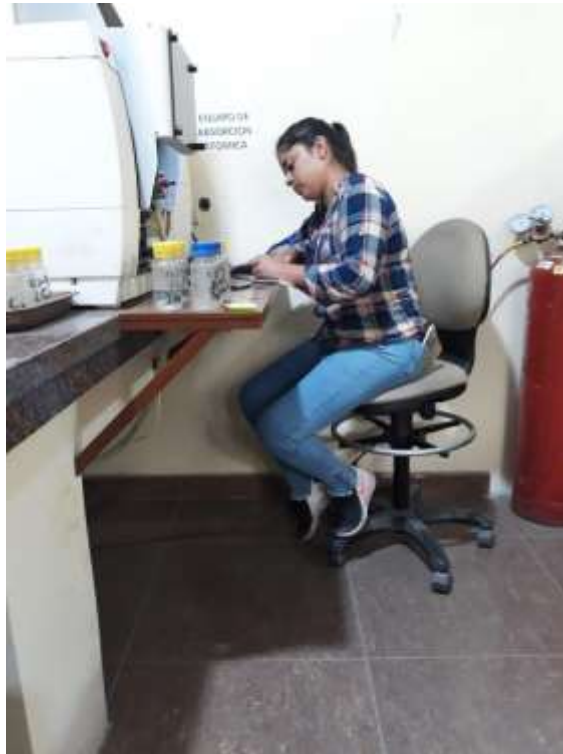
Anexo 14 Lectura de las muestras en el equipo de absorción atómica
