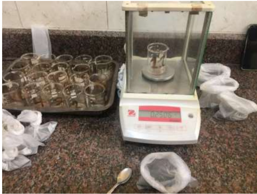
Anexo 12 Pesado del concentrado obtenido en el proceso de flotación
