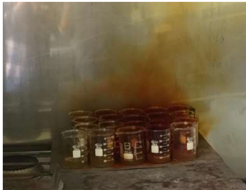
Anexo 13 Digestión ácida de las muestras de flotación
