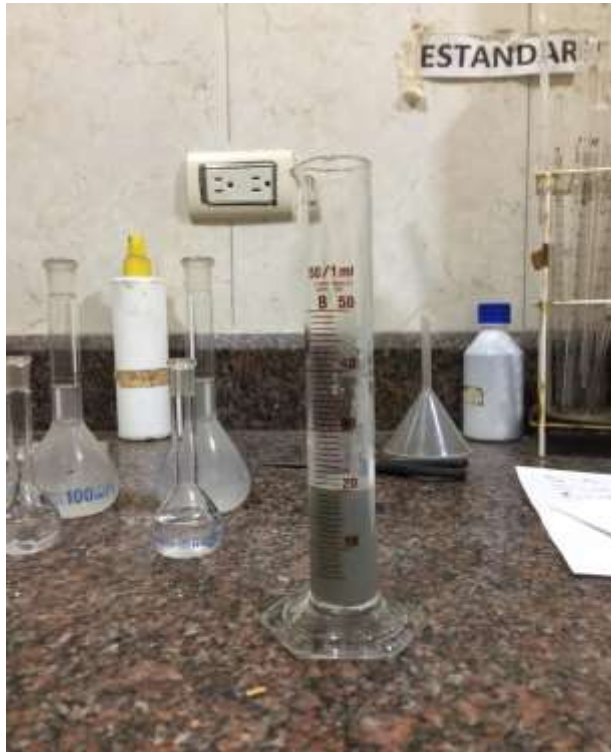
Anexo 6 Determinación de la densidad aparente del relave
