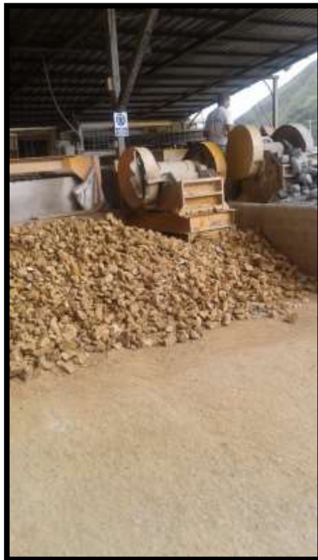
Gráfico 8. Planta de beneficio. Molienda del material
