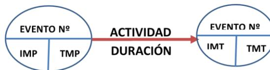
Fig. 2: Diagrama CPM para un elemento de trabajo
