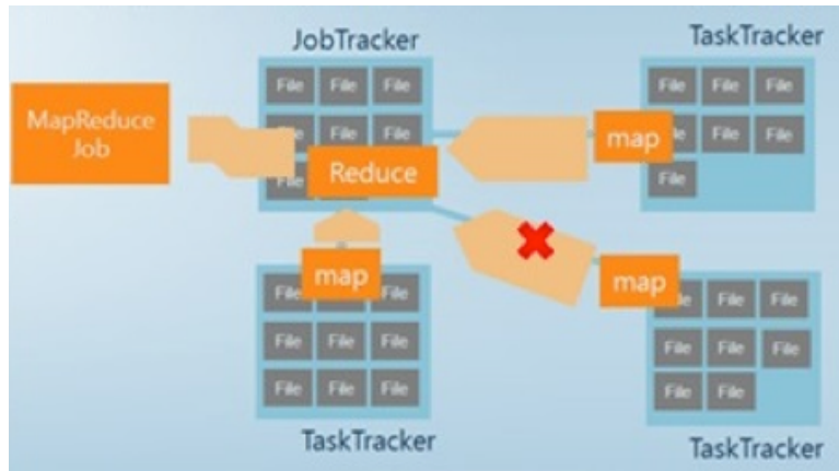
Figura 3: Esquema del Framework MapReduce
