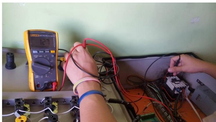
**Descripción:** Realización de la prueba de continuidad desde el contactor hacia los interruptores de on/off del TCI
