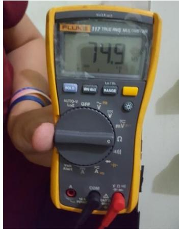
Figura 51: Medición de resistencia eléctrica
