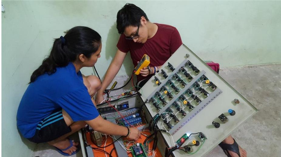
**Descripción:** Realización de la prueba de aislamiento, usando un multímetro Fluke 117, verificando la resistencia existente en el TCI.
