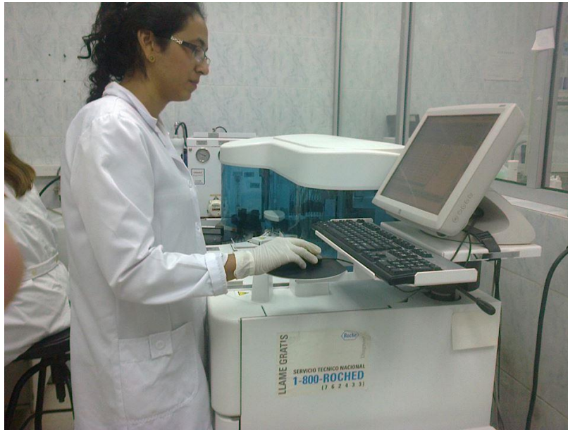
Foto 5.- Analizando muestras en el equipo de química sanguínea COBAS C-311
